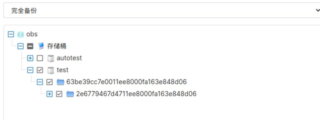
3. 选择【备份主机】。代理端需要安装 OBS 模块，所选的代理端要确保能与对象存储主机通信。
